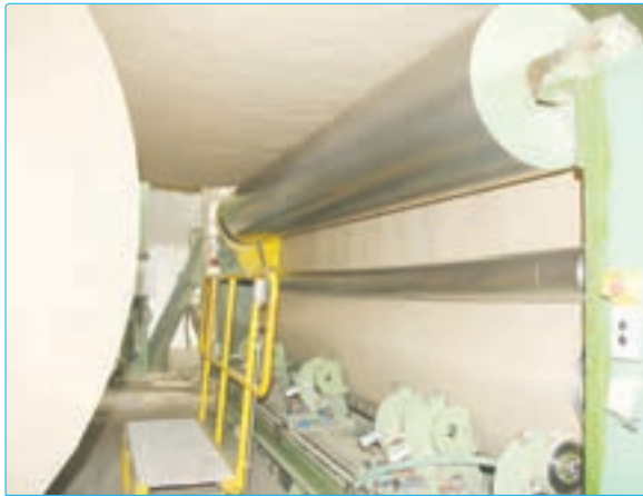
غلتک آهنی برای صاف کردن خمیر کاغذ
